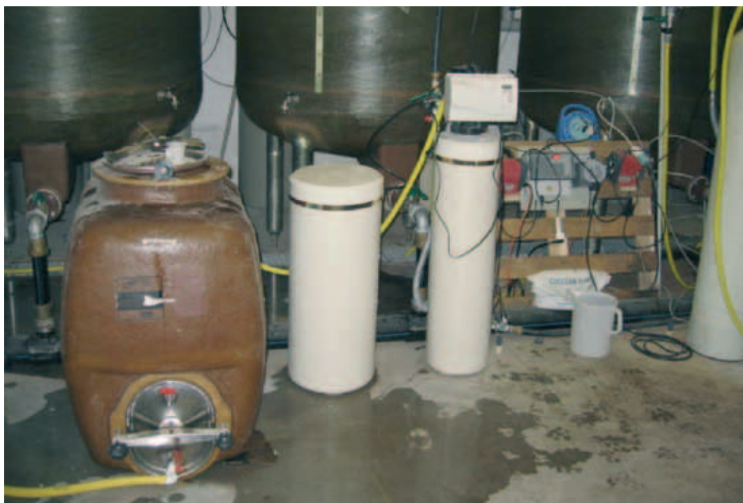
Foto 1 – Impianto pilota installato presso Mediterranea S.p.A. Si osservano, da sinistra a destra, il serbatoio per la raccolta delle acque di rigenerazione, il contenitore della salamoia e lo scambiatore ionico.
